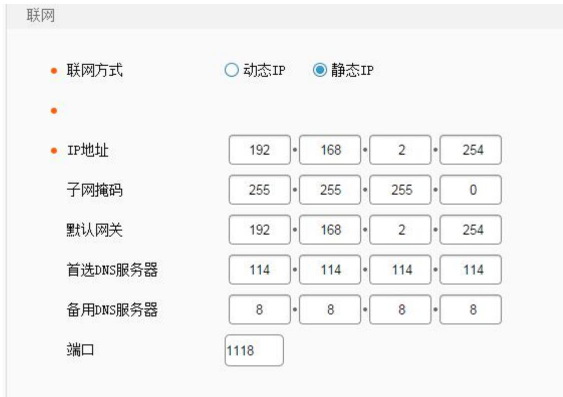
6. 系统自动重启，启动完毕后，进入云控板设置服务器参数：若有摄像头，摄像头 IP 要与上面设置的静态 IP 在一个网段。每个门的摄像头、读头都可以指向单独的服务器 IP，可下拉菜单分别设置，也可直接设置成全部门生效。
