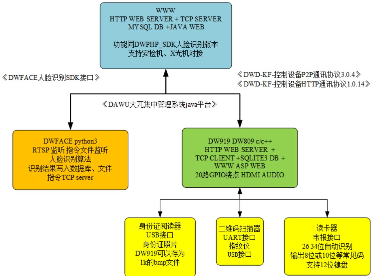
平台完全实现了与《DWD-KF-控制设备 P2P 通讯协议 3.0.4》、《DWD-KF-控制设备 HTTP 通讯协议 1.0.14》的应用层对接, 实现了对控制设备的集中管理。即可以对控制设备实时上传的字符串、图片等数据完成解析处理, 实时返回控制指令, 让控制设备实时完成多个接点的分别开闭、LCD 图像内容的显示、音频播放等功能, 也可以通过长连接进行 P2P 穿透远程控制、下发指令。用户无需重复开发, 不用关注通讯细节, 进行繁琐解析, 直接调用类库函数、操作数据库、文件即可获得或下传应用数据, 可以集中关注业务逻辑的实现。也实现了与《DWFACE 人脸识别 SDK 接口》的对接, 与 PHP 语言实现的 DWPHP\_SDK 其中人脸识别版本一样, 支持对一些安检机、X 光机的接口。
